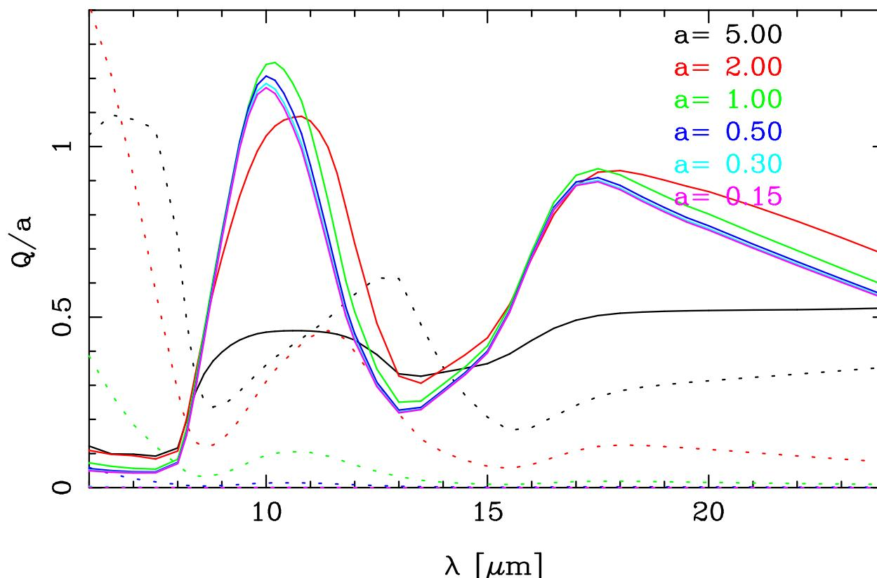
DHS  $\text{Mg}_{0.8}\text{Fe}_{1.2}\text{SiO}_4$ : effect of grain size.
