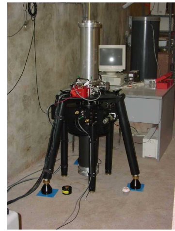
Figure 3 : le gravimètre absolu FG5#202 déterminant la pesanteur à Membach avec une précision de 10^{-9} g. En fonction des saisons, la valeur de g y varie de 9,810 467 20 à 9,810 467 30 m/s 2 , après correction des effets variables connus tels les marées. Il n'y a actuellement qu'une trentaine de ces instruments en service dans le monde.
