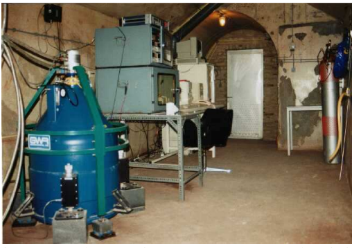
Figure 4 : le gravimètre à supraconductivité GWR#C021 mesure en continu les variations de pesanteur à Membach avec une précision de 10^{-10} g. C'est un des vingt gravimètres de ce type en service dans le monde.
