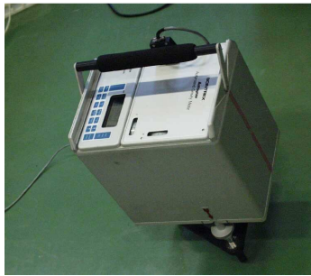
Figure 2. Le gravimètre à ressort Scintrex CG3M est l'un des instruments de terrain de l'Observatoire qui mesure les variations de pesanteur avec une précision de 10^{-8} de g.
