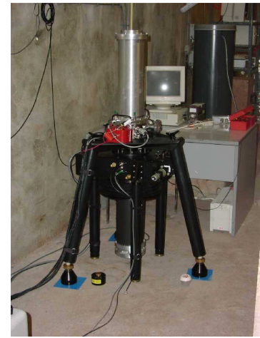
Figuur 3 : De absolute gravimeter FG5#202 bepaalt de valversnelling te Membach met een nauwkeurigheid van 10^{-9} g. In functie van de seizoenen en na correctie van gekende variabele effecten zoals de getijden varieert de waarde van g er van 9,810 467 20 tot 9,810 470 30 m/s 2 . Er zijn momenteel slechts een dertigtal zulke instrumenten in de wereld aan het werk.
